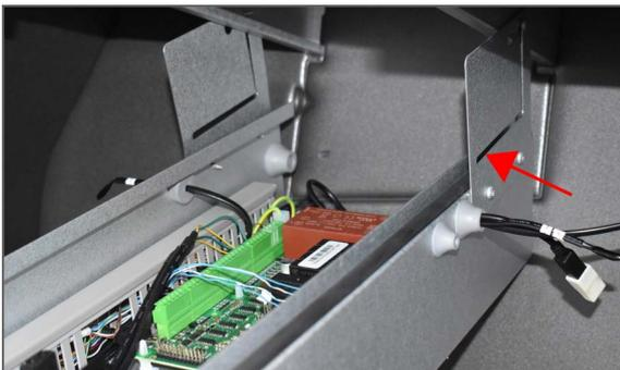
3. Die Steuerbox aus den Rillen ziehen, nach vorne neigen und am Profil hängen lassen.
